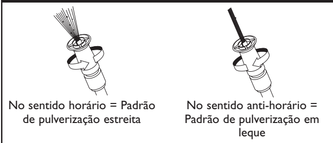
Figura 56 — Ajuste do Bico para Forma de Spray
